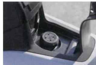
13,5 l-Tank im Mitteltunnel
